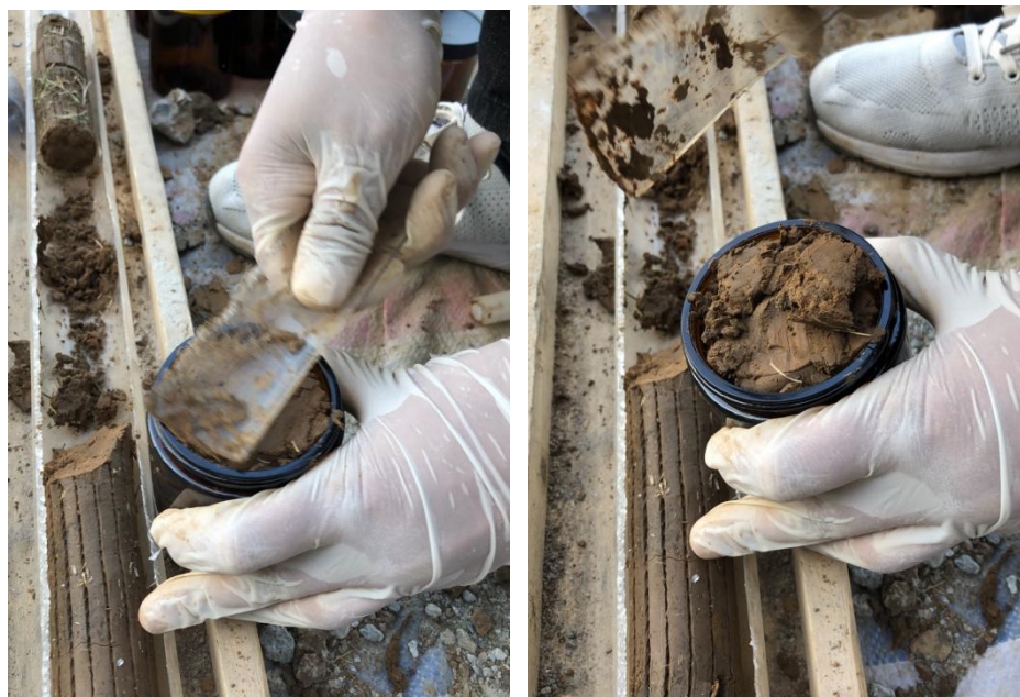
图 4.4-2 半挥发性有机物现场采样照片
